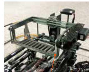
カメラジンバル エンルートオリジナルのカメラジンバルも搭載可能。(オプション)
