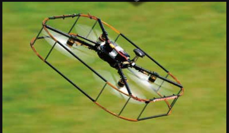
Zionオリジナルの高性能バッテリー、Li-Po 3セル 38Whによるパワフルなフライト。ペイロードなしで約10分のフライトが可能となっています。
