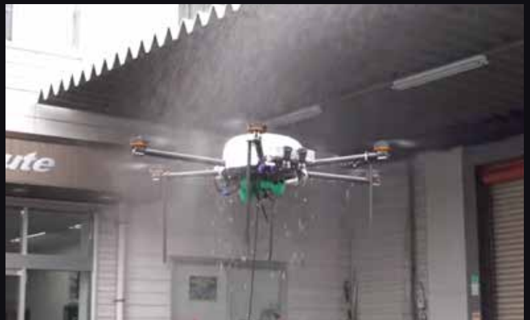
エンルートが独自開発した防滴システムにより、雨天中での作業にも対応。 ※防滴仕様はオプションです
