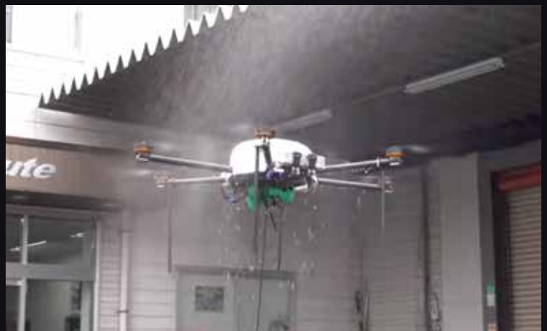
エンルートが独自開発した防滴システムにより、雨天中での作業にも対応する全天候型。
