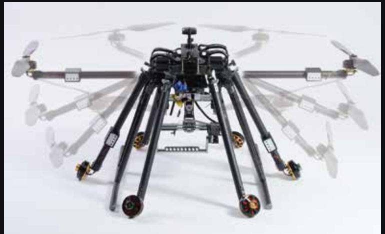
モーターアームは折り畳み式で、運用に必要な機材一式を専用ハードケースに収納可能。
