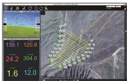
フライトシミュレーションソフト「ミッションプランナー」により、ルートを設定した自動航行が可能（バッテリー使用時）
